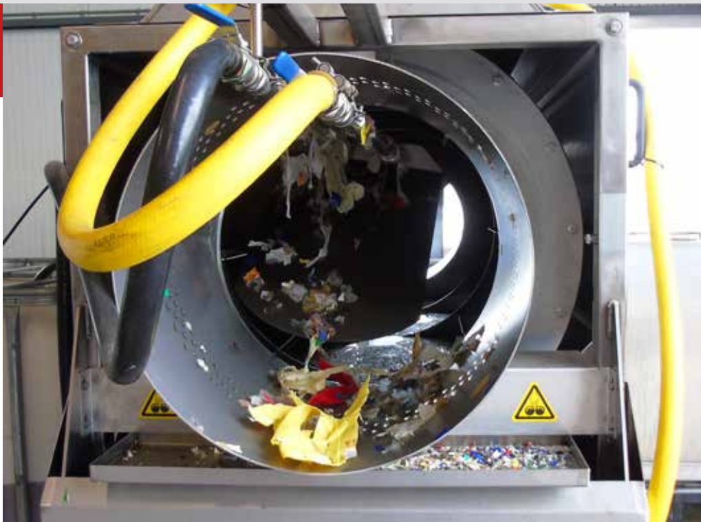
Het kunststof dat TUSTI verwerkt is HDPE, dat in een soort wastrommel met een plantaardig schoonmaakmiddel wordt gereinigd.
