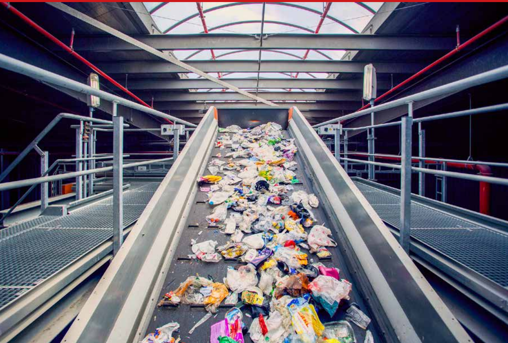
Sorteerlijn voor zacht kunststof verpakkingsafval, dat door steeds meer Nederlandse gemeenten wordt ingezameld.
