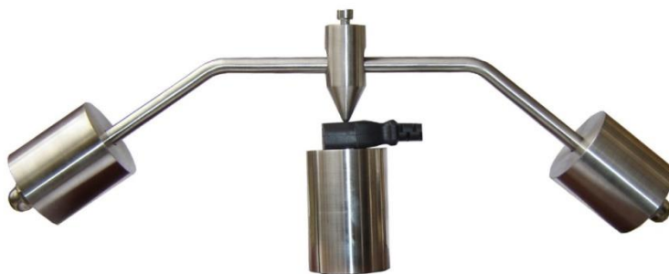
Afbeelding 6: Ball pressure test opstelling
